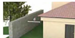
L Distance minimale à un obstacle - Distance minimale à la limite de propriété. d > 3 m par rapport à tout obstacle (mur, haie...). d > 3 m par rapport à la limite de propriété avec habitation voisine. d > 6 m par rapport à la limite de propriété en l'absence d'habitation voisine.
